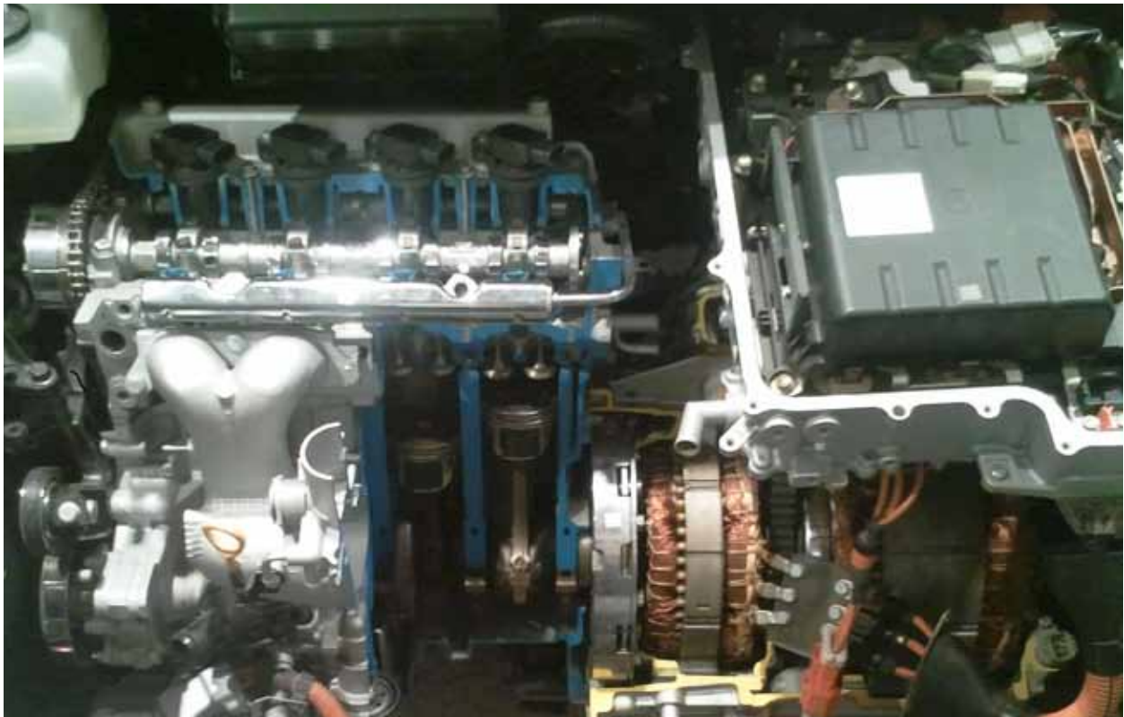
Der Antrieb des Toyota Prius mit leistungsverzweigtem Getriebe: Ein komplexes technisches System als Vorbild für ein Gemeinschaftsprojekt von Auszubildenden und Studenten. Foto: Lars Dönicke
