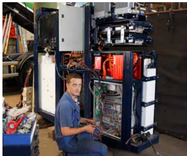
Kfz-Elektriker Ronny Glissmann bei Wartungsarbeiten an der Steuerungseinheit des Hybridfahrzeugs.
