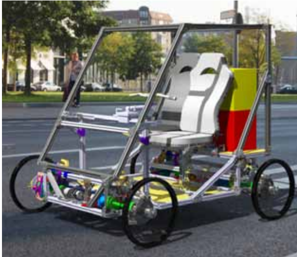
CAD-Modell des BCV in einem frühen Entwicklungsstadium. Fotos: TU Berlin (2)
